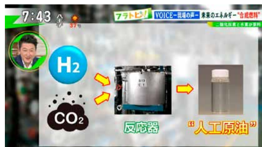
水素と二酸化炭素でできる合成燃料 (TOKYO MX ホームページより)
